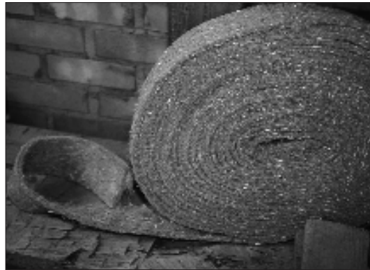
Trittschallstreifen aus Hanf für gute Schalldämmung.
